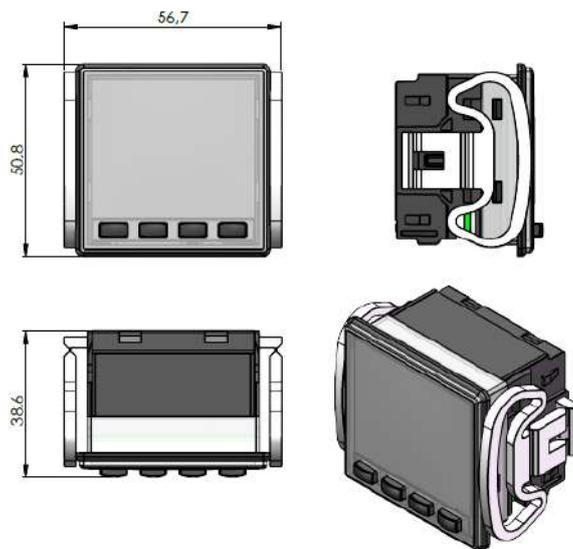
Figura 18 – Dimensões do equipamento
