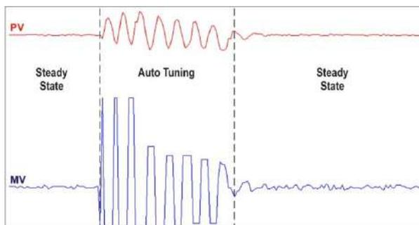
Figura 37 – Exemplo de sintonia automática
