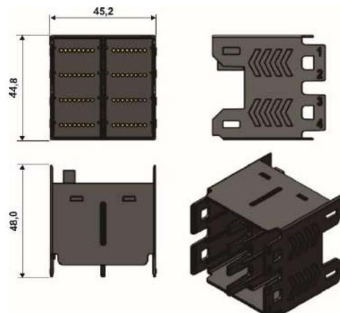
Figura 20 – Dimensões do bastidor
