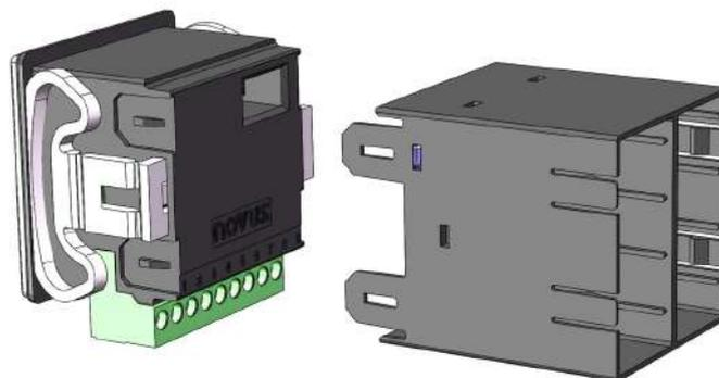
Figura 17 – Instalando o bastidor no controlador
