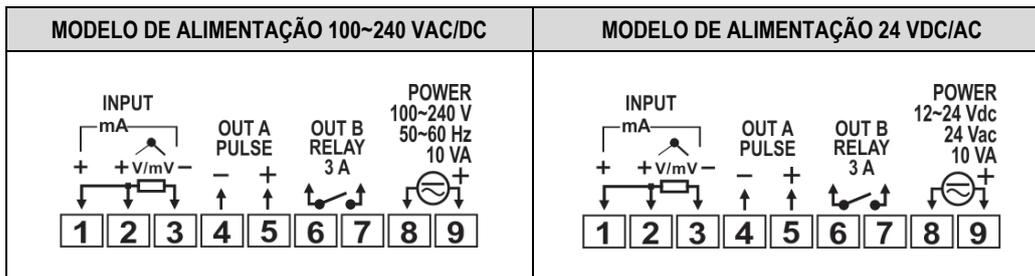
Figura 7 – Etiquetas de conexões elétricas
