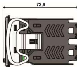
Figura 19 – Dimensões do equipamento com o bastidor
